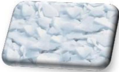
La glace en écaïlle est une glace hydrique morcelée, sous-refroidie et sèche. La taille des écaïlles est de 5 à 10 centimètres carrés environ et leur température d'approximativement - 8°C et une épaisseur supérieure à 2,0 mm.
